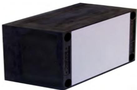
Fixer le Blochet PU Fixation universel 138x138mm de l'épaisseur identique que l'EPS de façade pour que le Blochet PU Fixation universel soit contre le mur de façade existant, fixations des 4 ancrages métalliques et fermeture des différents orifices avec la mousse PUR Adam Matériaux.
