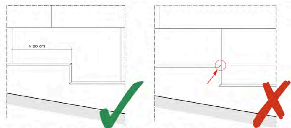
Placement d'un panneau en une seule pièce à la jonction de profilés au droit d'une « marche » d'un pied de mur en escalier
